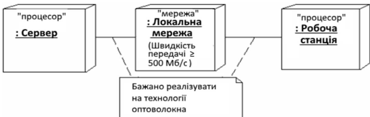
Рисунок 3.53 – Фрагмент діаграми розгортання зі з'єднаннями між вузлами
