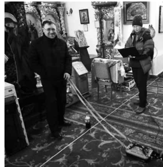
Виконання вимірювань в Іллінській церкві з георадаром VIY-3-500. 2019 р.
