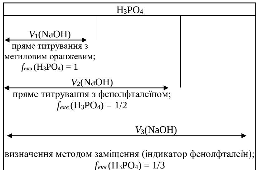
Схема аналізу розчину фосфатної(V) кислоти методом кислотно-основного титрування з різними індикаторами.
