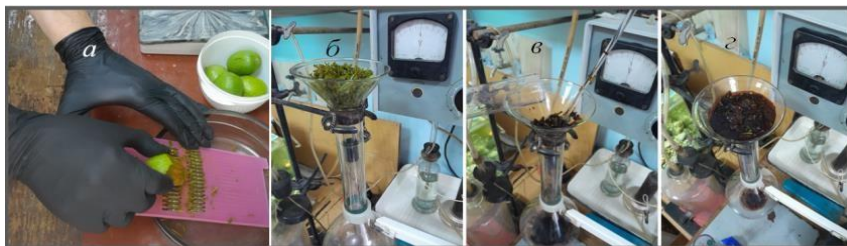
Рис. 1. Етапи приготування лужного екстракту перикарпії горіха а – подрібнення; б – завантаження в колбу; в, г – заливка розчином лугу
