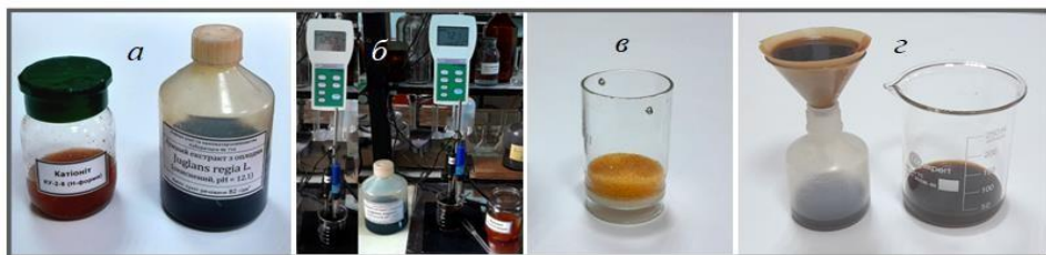
Рис. 3. Стадії виділення суми відновників з лужного екстракту а – вихідний екстракт; б – додавання катіоніту при рН-метричному контролі; в – відфільтрований катіоніт; г – фільтрування через паперовий фільтр
