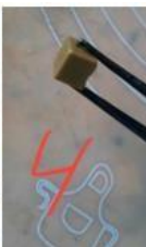
10. Вигляд зразків композитів (після витримки в \text{HNO}_3 )
