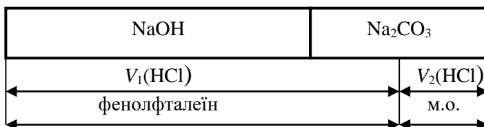
Рис. 2.19. Схема титрування однієї аліквоти суміші NaOH і Na 2 CO 3 розчином HCl з двома індикаторами: фенолфталеїном і метиловим оранжевим.
