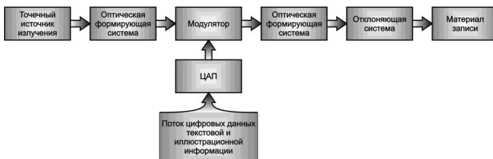
Рис. 1. Функциональная блок-схема РСУ записи
