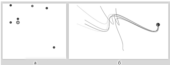
Рисунок 2 – Відтворення процесу консолідації: а – початкове положення агентів; б – положення агентів після виконання консолідації навколо лідера та їх залишкові траєкторії
