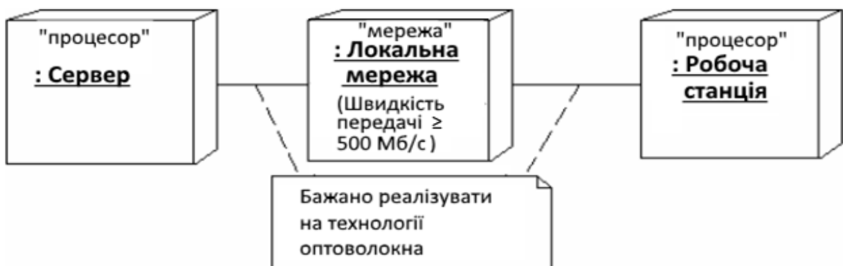
Рисунок 3.53 – Фрагмент діаграми розгортання зі з'єднаннями між вузлами
