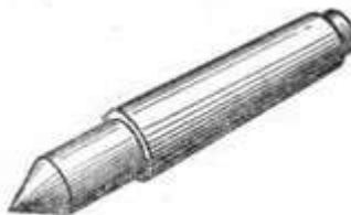
Рис. 2.2.24. Упорний центр токарного верстата
