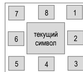
Рис. 2. Схематическое изображение допустимых позиций расположения символов относительно текущего рассматриваемого символа
