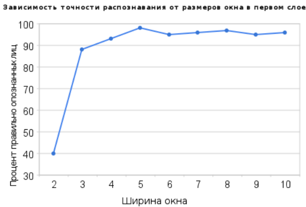
Рис. 3. Зависимость точности распознавания от размеров окна в первом слое
