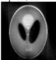
Рис. 8. Результат восстановления фантома с помощью итерационного метода (90 снимков, 1 итерация)
