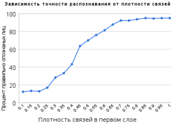
Рис. 2. Зависимость точности распознавания от плотности связей
