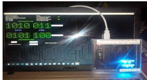
Рис. 21. Відтворення штатними світлодіодами значення істинного байту 5Ah після корекції помилок в пакетах
