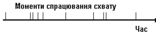
Рисунок 1.20 –Тестова послідовність сигналів датчика схвату
