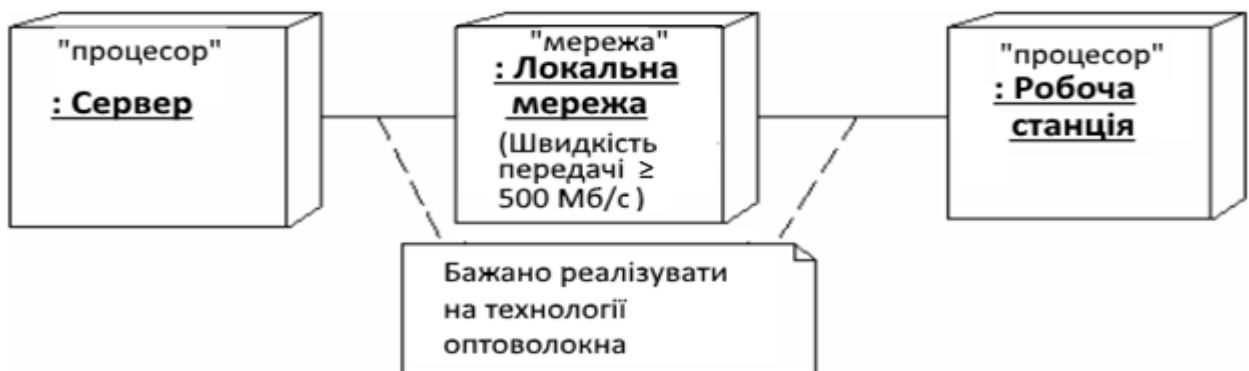
Рисунок 2.53 – Фрагмент діаграми розгортання зі з'єднаннями між вузлами
